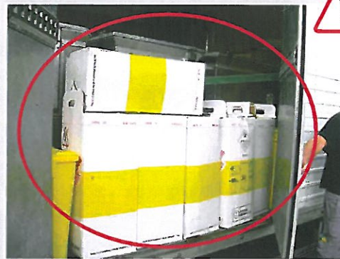
Caisson solidaire non conforme (véhicule non adapté, car équipé d'un plancher en bois, donc non lavable)
