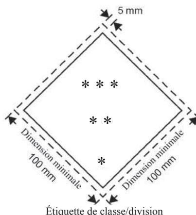
\* La classe, le chiffre 4 pour les classes 4.1, 4.2 et 4.3 ou le chiffre 6 pour les classes 6.1 et 6.2 doit figurer dans l'angle inférieur.
